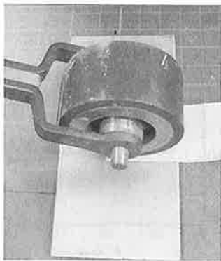
写真-3 布粘着テープの貼り付け
