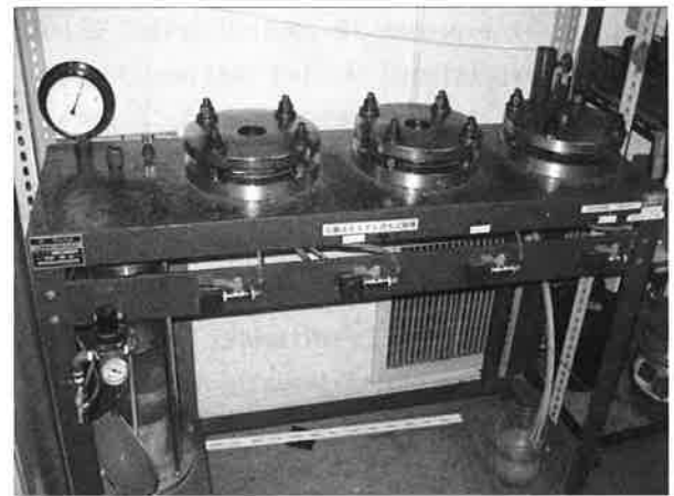
図-5 透水性試験状況
