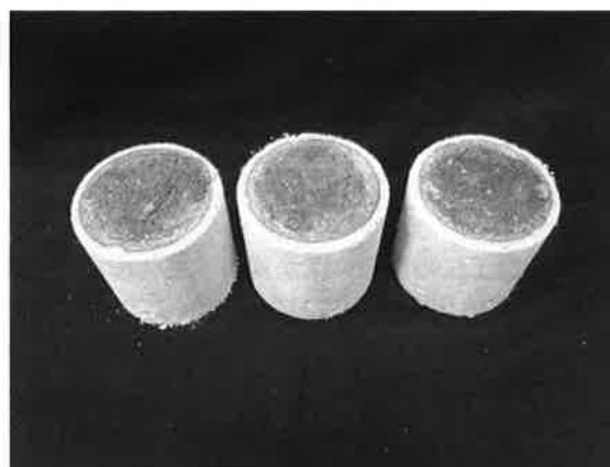
図-1 硫酸浸透深さの試験体（フェノールフタレイン噴霧後）
