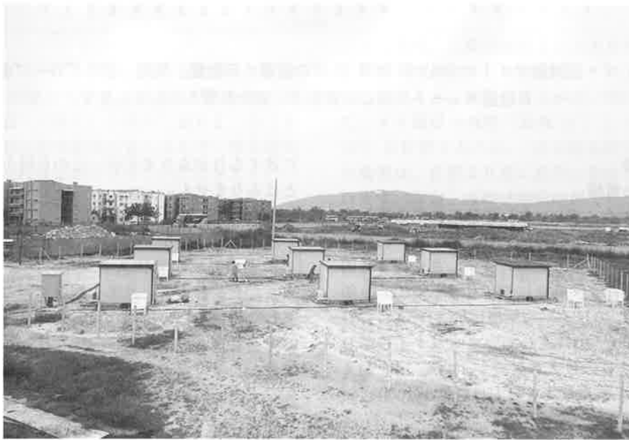
写真 2.1 タイ国の試験サイトに建設したプレハブ式実験棟と簡易ボックス
