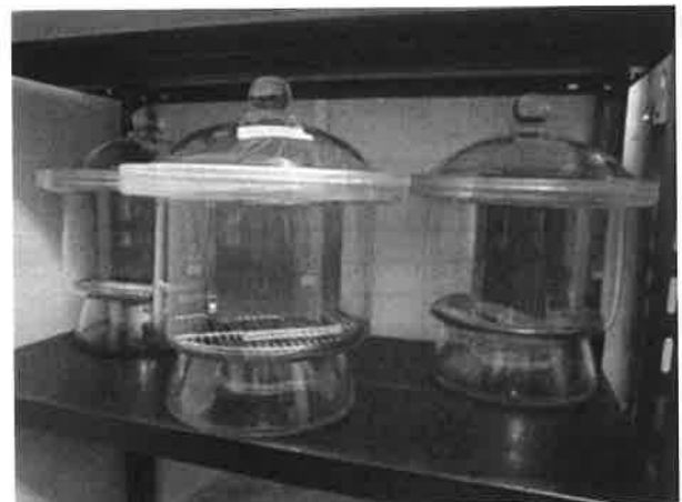
写真2 デシケーター法試験中
