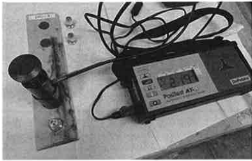
図-3.2 付着試験箇所と付着性試験状況
