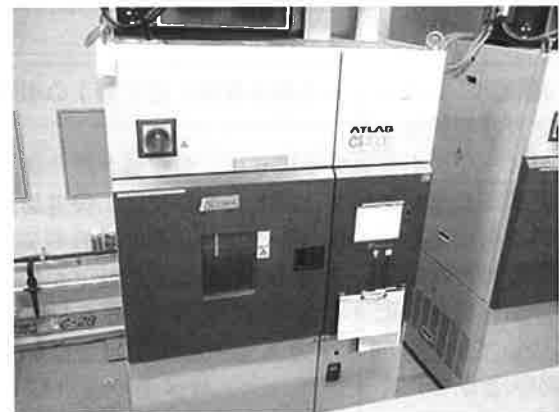
図5 XeWOM 促進暴露試験機 (Ci4000)
