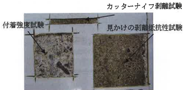
写真 3.5 試験方法による破壊箇所の違いの一例
