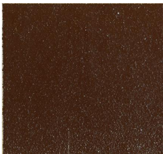
図-7 断熱材に遮熱塗料を塗装した試験板（ブラウン）
