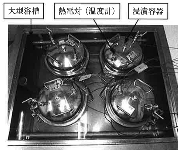
図9 大型浴槽に浸漬容器を設置した様子
