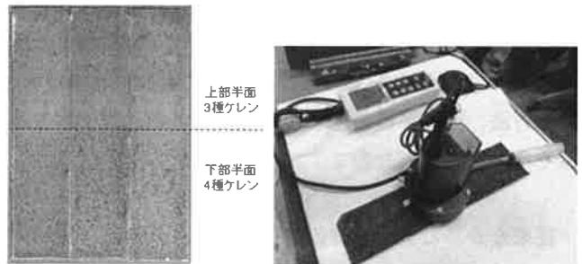
図-2.1 試験片基板(錆鋼板) 写真-2.1 付着塩分量の測定状況
