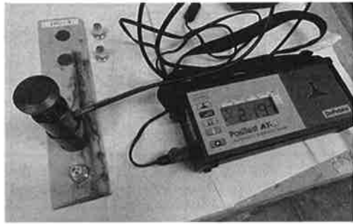
図-3.2 付着試験箇所と付着性試験状況
