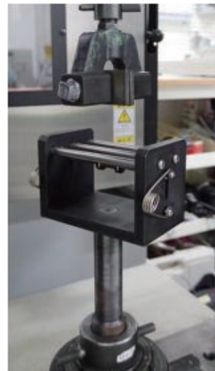
図-3 90°引張り試験装置
