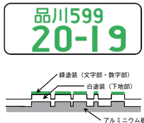
図-2 シート式特別仕様ナンバープレート及びペイント式ナンバープレートの構造概略図
