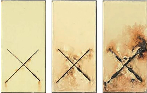
図-1 塗膜劣化の一例（カット部のさび・膨れ）
